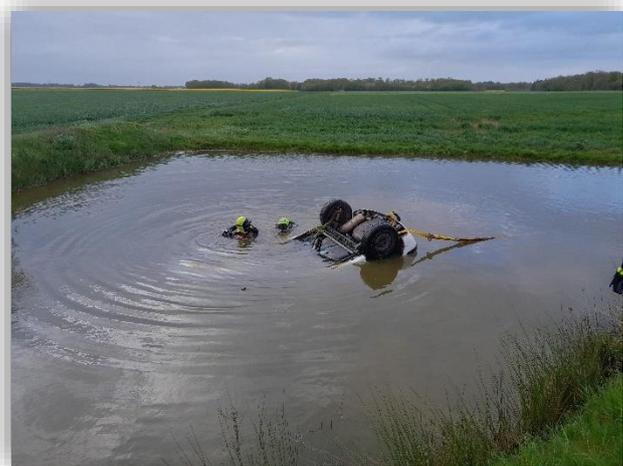
Le dégagement de la victime n'est pas possible car le véhicule est envasé. Le véhicule est alors sorti de la mare à l'aide du treuil du VSR amarré au VL par les plongeurs.
